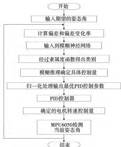
图8 模糊神经网络PID控制器的算法设计流程图
